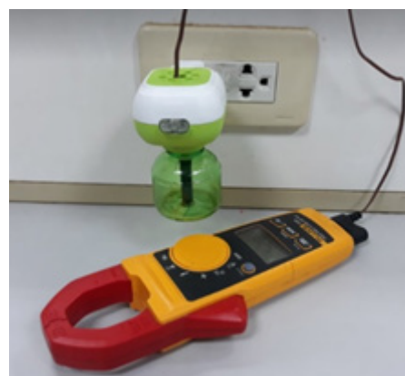
ภาพ 9 การตรวจวัดอุณหภูมิที่แกนกลางของขดลวดความร้อนสำหรับเครื่องไถ่แบบใช้ในครัวเรือน
