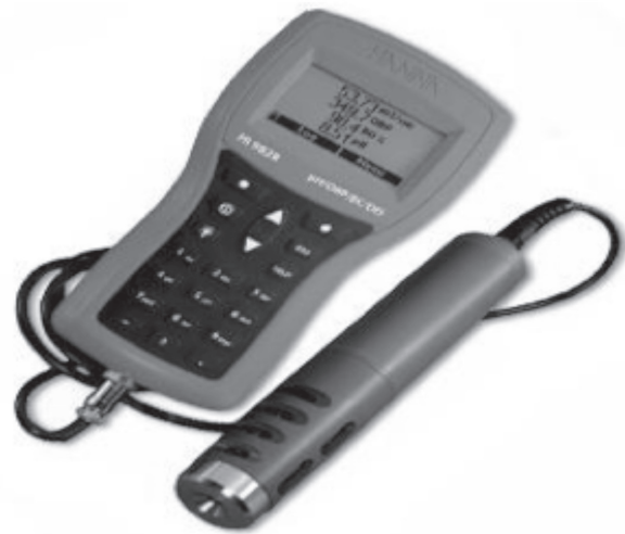
ภาพ 7 เครื่องเซ็นเซอร์เชิงแสงสำหรับวัดออกซิเจนที่ละลายน้ำได้
