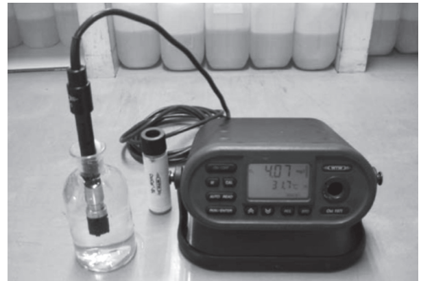
ภาพ 3 เครื่องมือวิเคราะห์หาปริมาณออกซิเจนที่ละลายน้ำทางเคมีไฟฟ้า
