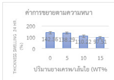
ภาพ 10 กราฟแสดงความสัมพันธ์ระหว่างค่าการขยายตัวตามความหนากับปริมาณยางเครฟ
