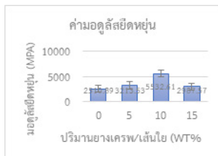
ภาพ 12 กราฟแสดงความสัมพันธ์ระหว่างค่าความต้านทานมอดูลัสยืดหยุ่นกับยางเครฟ
