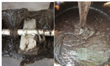
ภาพ 5 แสดงการผสมยางเครพที่แช่ในสารละลาย \text{Na}_2\text{CO}_3 กับผงต้นมันสำปะหลังที่อัตราส่วนร้อยละ 15
