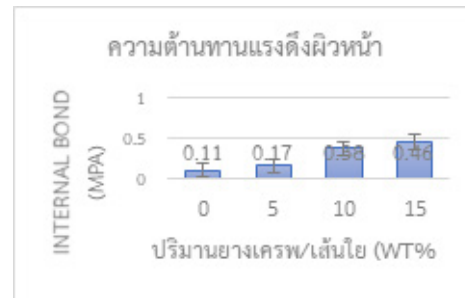
ภาพ 14 กราฟแสดงความสัมพันธ์ระหว่างค่าความต้านทานแรงดึงผิวหน้ากับยางเครฟ
