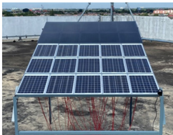
ภาพ 10 การจัดเรียงโมดูลแบบเมจิกสแควร์ MS1 การบังเงาบางส่วน SW
