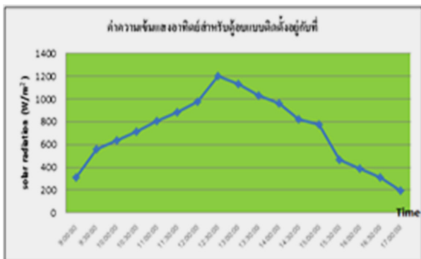
ภาพ 14 ค่าความเข้มพลังงานแสงอาทิตย์ที่ทำการตรวจวัดสำหรับการทดสอบตู้อบแห้งแบบติดตั้งอยู่กับที่
