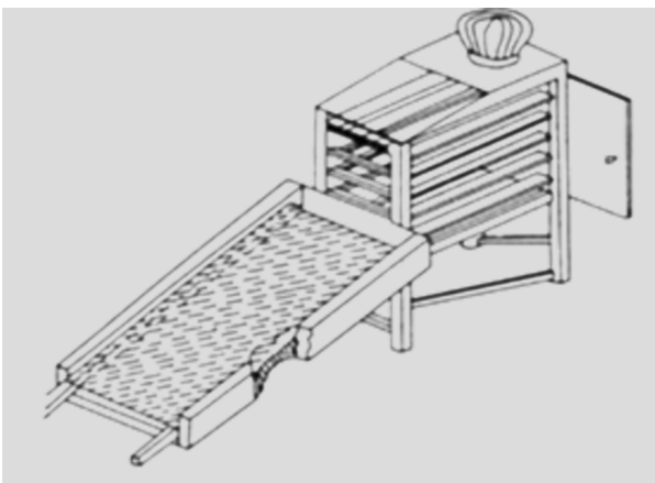
ภาพ 3 เครื่องอบแห้งพลังงานแสงอาทิตย์แบบรับรังสีอาทิตย์อ้อม
