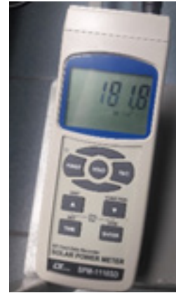
ภาพ 10 เครื่องวัดพลังงานแสงอาทิตย์ Lutron SPM1116 SD solar power meter
