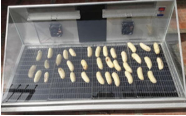
ภาพ 2 เครื่องอบแห้งพลังงานแสงอาทิตย์แบบรับรังสีอาทิตย์โดยตรง
