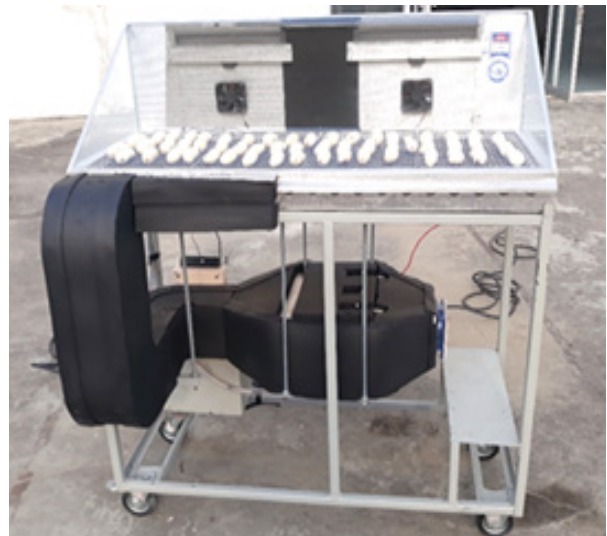
ภาพ 19 การทดสอบตู้อบแห้งพลังงานแสงอาทิตย์แบบผสมผสานในวันที่ท้องฟ้าแจ่มใส
