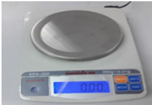
ภาพ 8 ตาชั่งดิจิตอลยี่ห้อ Zepper รุ่น EPS-302
