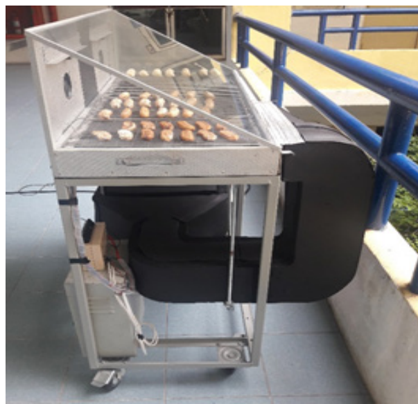
ภาพ 22 การทดสอบตู้อบแห้งพลังงานแสงอาทิตย์แบบผสมผสานในวันที่ฝนตกและมีเมฆปกคลุม (ทำการตากภายในอาคาร)
