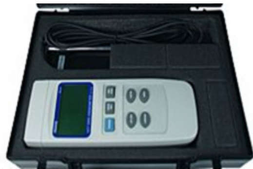
ภาพ 11 เครื่องวัดความเร็วลมแบบใช้ลวดนำความร้อน Digicon DA 47
