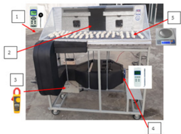
ภาพ 12 จุดติดตั้งเครื่องมือวัดทำการเก็บผลการทดสอบตู้อบแห้งพลังงานแสงอาทิตย์แบบผสมผสาน
