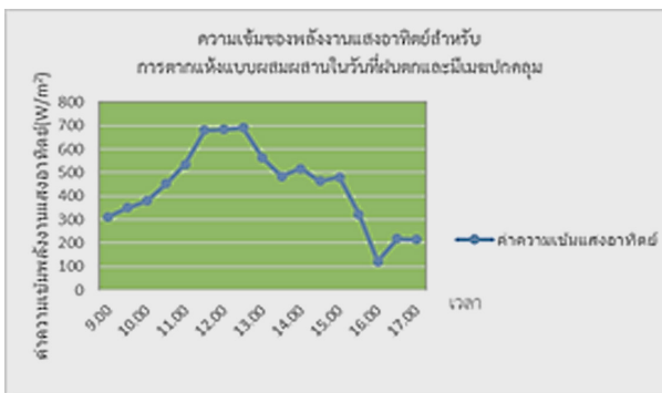
ภาพ 20 ค่าความเข้มพลังงานแสงอาทิตย์ที่ทำการตรวจวัดสำหรับการทดสอบตู้อบแห้งพลังงานแสงอาทิตย์ในวันที่ฝนตกและมีเมฆปกคลุม
