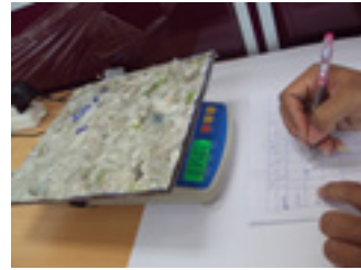
ภาพ 6 การบันทึกค่าการดูดซึมน้ำการผลิตกระเบื้องหลังคาจากพลาสติกพอลิเอทิลีนจากกล่องดื่มที่ใช้แล้วร่วมกับของเหลือใช้ทางการเกษตร
