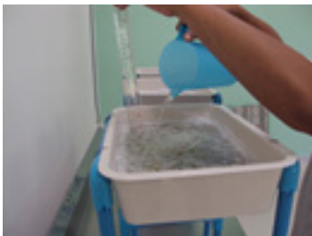
ภาพ 5 การทดสอบการรั่วซึมน้ำการผลิตกระเบื้องหลังคาจากพลาสติกพอลิเอทิลีนจากกล่องดื่มที่ใช้แล้วร่วมกับของเหลือใช้ทางการเกษตร
