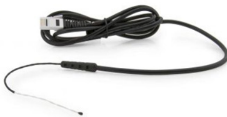
ภาพ 5 เครื่องมือวัดอุณหภูมิผิวผนัง (surface temperature probe)
