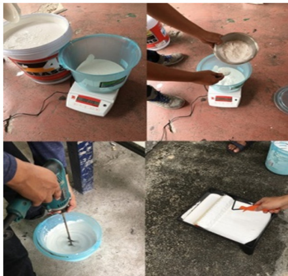
ภาพ 8 การผสมซิลิกาแอรโรเจลในสีทาอาคาร
