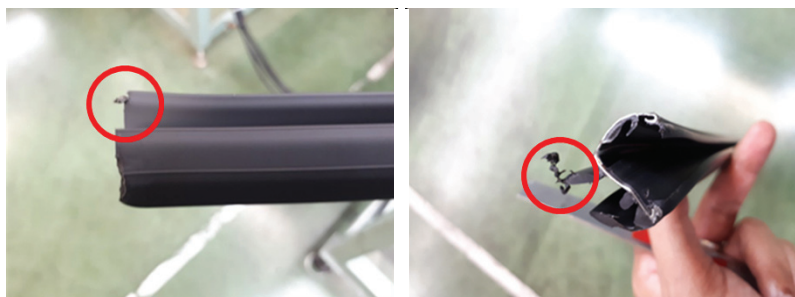
ภาพ 8 แสดงลักษณะของการเกิดเศษบริเวณปลายลิบของชิ้นงานทั้งสองฝั่ง
