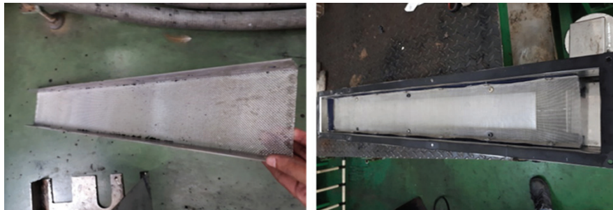
ภาพ 10 เปรียบเทียบตะแกรงร้อนกัมมะหยี่ ก่อนและหลังการแก้ไข
