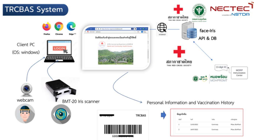
ภาพที่ 2 แผนผังกระบวนการทำงานของระบบ TRCBAS
