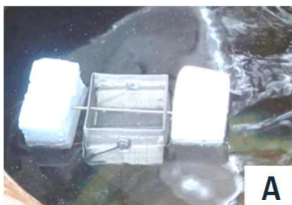
ภาพที่ 2 อุปกรณ์เช็คผล A. กระชังลอยลูกน้ำ และ B. กรงลอยลูกน้ำแบบปล่อยอิสระ
