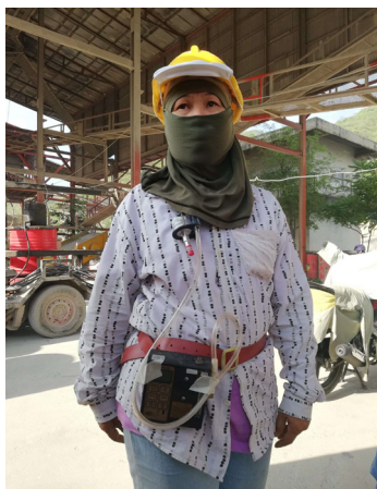
ภาพที่ 2 ชุดอุปกรณ์เก็บตัวอย่างฝุ่นละอองแบบติดตัวบุคคล
