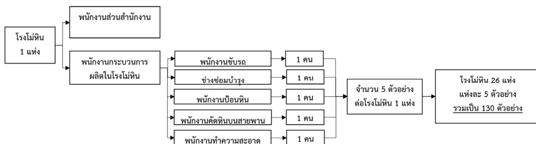
ภาพที่ 3 เทคนิคการสุ่มเก็บตัวอย่างฝุ่นละอองในโรงโม่หิน
