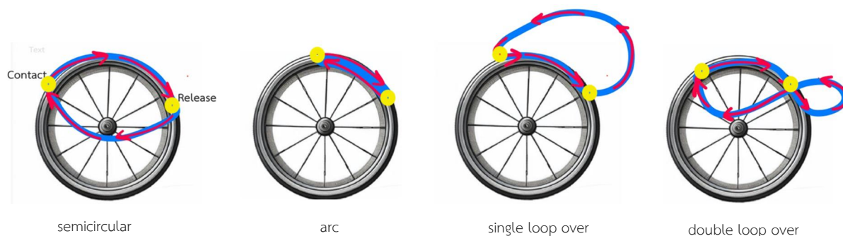
ภาพที่ 6 แสดงรูปแบบการปั่นล้อวีลแชร์ 4 ชนิด ได้แก่ การปั่นแบบครึ่งวงกลม (semicircular) แบบโค้งตามวงล้อ (arc) แบบหนึ่งวง (single loop over) และ แบบสองวง (double loop over) (ที่มา: ประยุกต์จาก Koontz et al., 2009)
