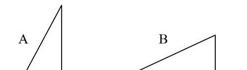
รูปที่ 9 แสดงรูปร่างของกระแสไฟรูปร่างสามเหลี่ยมที่ทำให้เกิดความเคยชินต่อการกระตุ้น
